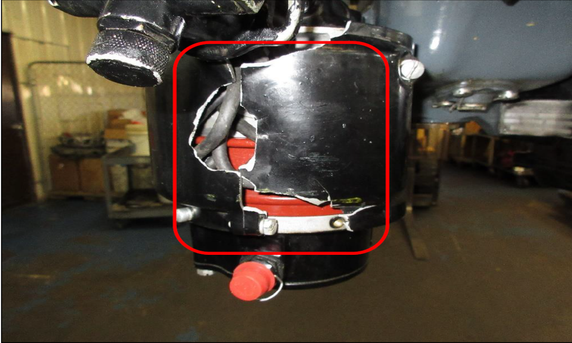
Fotografía No. 11: Magneto izquierdo con fractura post incidente grave.
