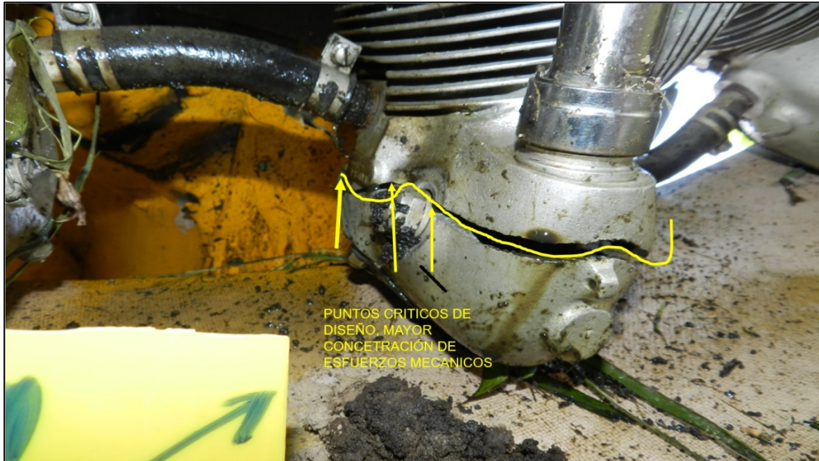
Fotografía No. 13: Puntos críticos de diseño para la carcasa del cilindro.
