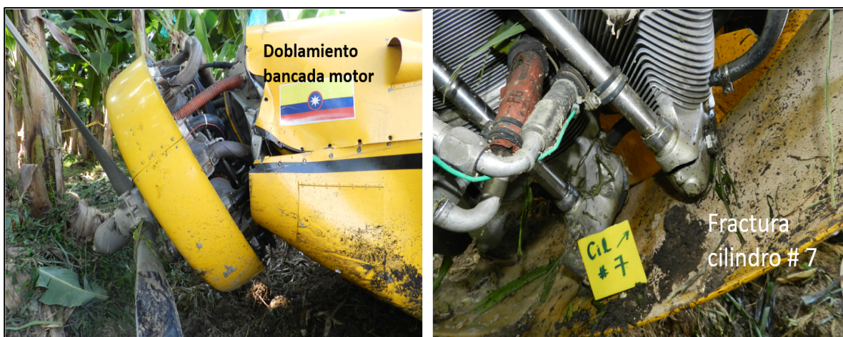
Fotografía No. 3 y 4: Daños en el motor y cilindro fracturado.
