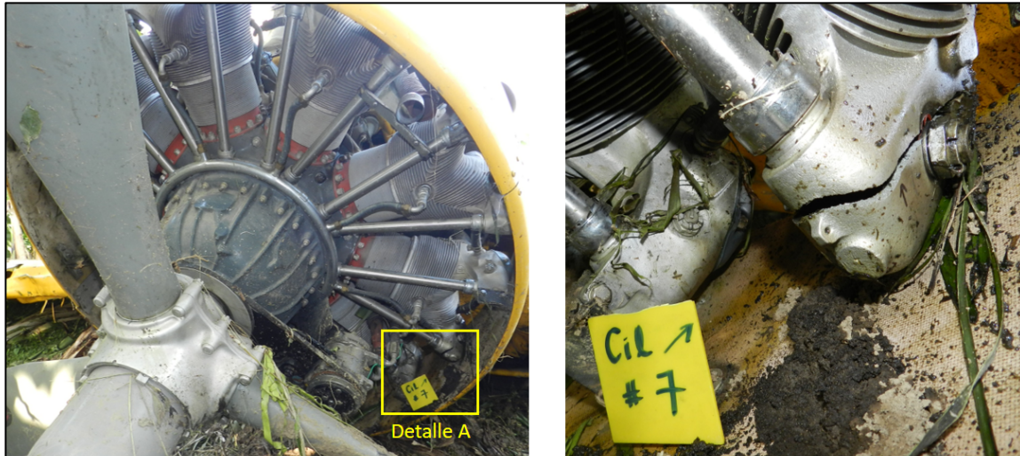
Fotografías No. 7 y 8: Fractura del cilindro No.7
