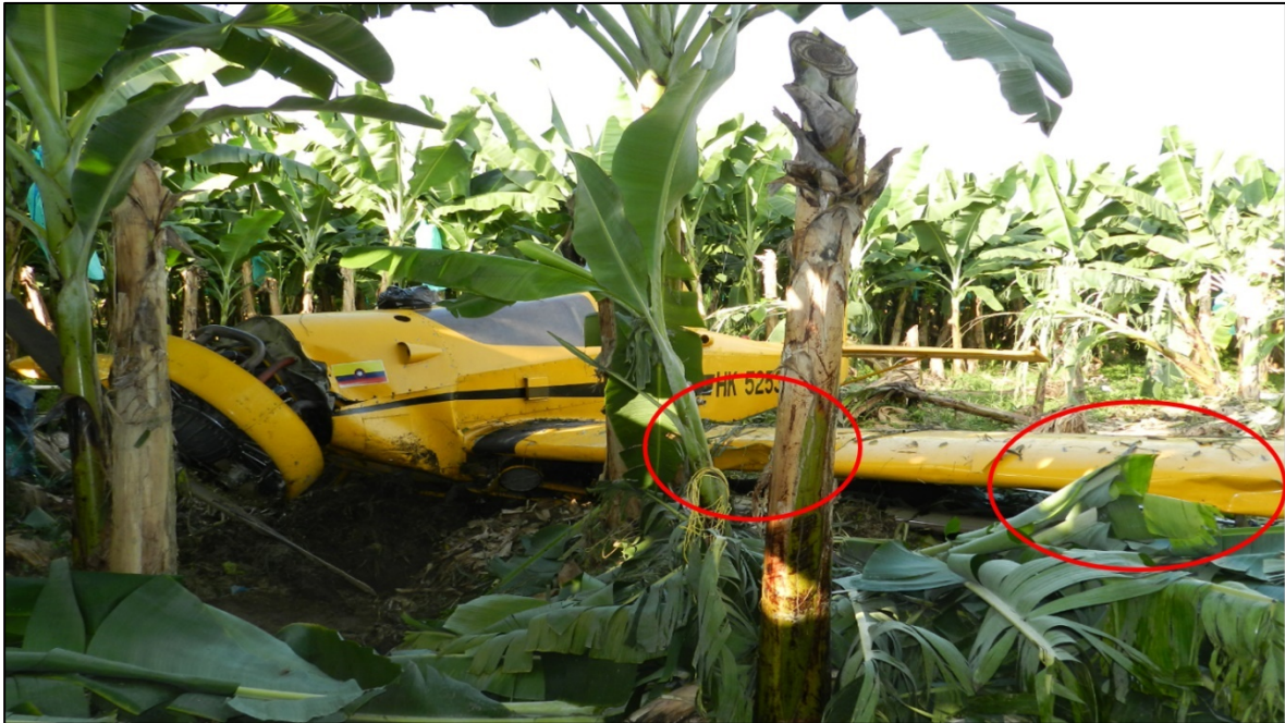
Fotografía No.2: daños en los planos de la aeronave
